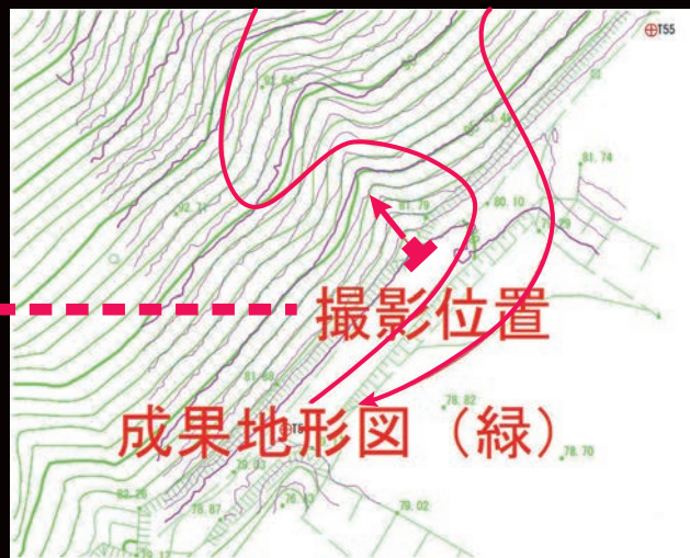
▲ 緑のライン／実測図、紫のライン／ハンディレーザー
